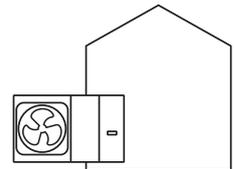
Diese Lösung ist kompakt, einfach zu montieren und spart Platz im Inneren des Gebäudes. Der Benutzer erhält ein komplettes, hermetisch abgeschlossenes, betriebsbereites Gerät, das weder die Installation durch einen Kältetechniker noch eine fachgerechte Inspektion erfordert. Bei dieser Lösung besteht die Notwendigkeit, das Heizmedium (Wasser) bei einem Stromausfall gegen Einfrieren zu sichern.
