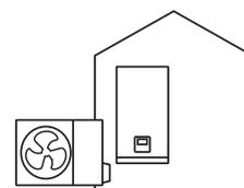
Der Aufbau des Gerätes, bestehend aus Innen- und Außengerät, erfordert eine fachgerechte Installation durch einen für die Arbeit mit Kältemittelgasen qualifizierten Fachmann. Der Vorteil dieser Lösung ist, dass bei einem Stromausfall keine Gefahr des Einfrierens des Heizmittels besteht. Im Gegensatz zu der Monoblok-Wärmepumpe befindet sich bei der Split-Ausführung nur das nicht gefrierende Kältemittel R32 außerhalb des Gebäudes.
