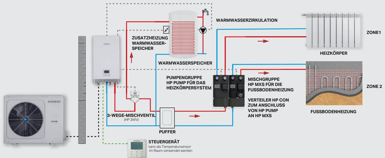
Steuerung der **ZONE 1** auf Basis der Wassertemperatur am Ausgang oder Heizkurve
