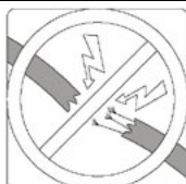
Sprawdzić urządzenie pod względem uszkodzonych przewodów
