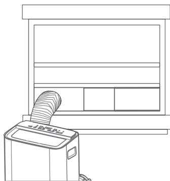
Montaż okna uchylnego
