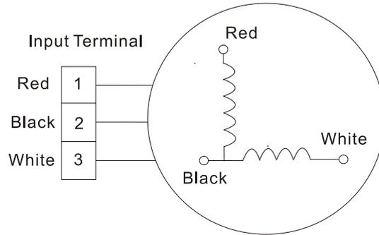
2. Indoor DC fan motor(control chip is inside fan motor)
