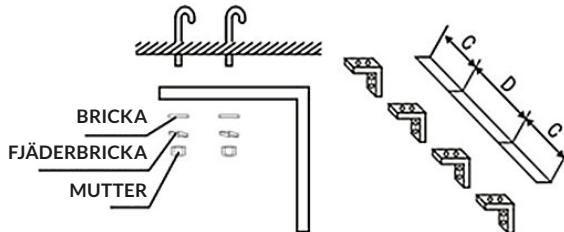
**4.3.3** Fastsätt monteringsplattan i takkonsolerna och säkerställ säker infästning (använd bultar som levererats tillsammans med takkonsolerna enligt fig.). Vid användande av takkonsoler för montering i taket kan monteringsplattan lägesjusteras inom 100mm gränser.
