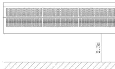
**3.4** W przypadku gdy otwór drzwiowy jest szerszy niż kurtyna, zalecany jest montaż dwóch lub więcej urządzeń. W tym przypadku, należy zapewnić wolną przestrzeń 20-40mm pomiędzy kurtynami.
