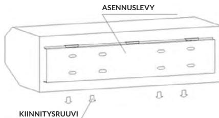
**4.3.2** Kattokiinnittimien asennus kuten kuvassa.
