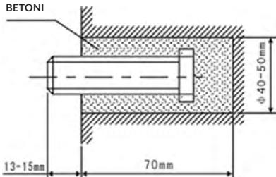
**4.1.3** Kun sementti on kovettunut, sovita kiinnityslevy (käytä aluslevyä ja mutteria noudattaen alla olevaa piirrosta).
