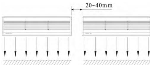
**3.5** Lämna inga spalter mellan enheten och väggen. När enheten installeras i taket använd medlevererade takkonsoler.
