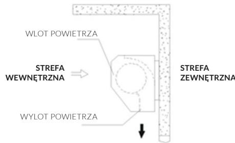
**3.3** Nie należy instalować urządzenia zbyt nisko, minimalna wysokość montażowa wynosi 2,3 metra.
