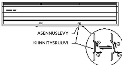
**4.1.2** Kiinnitä ruuvit oikeaan paikkaan (tarkista oikea paikka kiinnityslevyn avulla ja laita sementtiä pulttireikiin).
