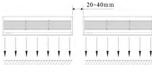
**3.5** Instalować urządzenie na dostarczonej w komplecie konsoli montażowej. Nie pozostawiać szczeliny pomiędzy ścianą a urządzeniem. W przypadku montażu do sufitu należy użyć uchwytów sufitowych.
