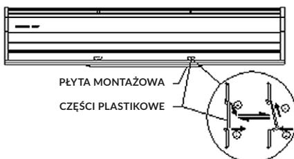
**4.1.2** Należy wywiercić otwory pod kołki rozporowe (ustalić ich położenie za pomocą płyty montażowej), które należy umieścić we właściwych miejscach.
