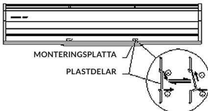
**4.1.2** Fixera bultarna i korrekt läge (bestäm läget med hjälp av monteringsplattan och fyll upp hålen för ankarbultarna med cement).
