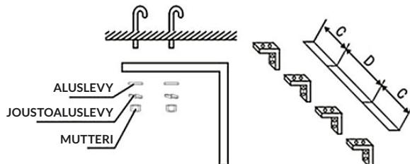
**4.3.3** Aseta asennuslevy kattokiinnittimiin, varmista kiinnitys ja turvallisuus (käytä mukana tulevia pultteja kuten kuvassa). Kattokiinnittimiä käytettäessä kattokiinnitykseen voi asennuslevyä säättää 100 mm:n rajoissa.
