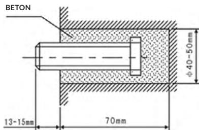
**4.1.3** Następnie przykręcić płytę montażową (zastosować kotwy do betonu, podkładki i nakrętki zgodnie z poniższym rysunkiem).
