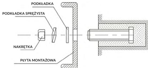
**4.1.4** Montaż urządzenia.
