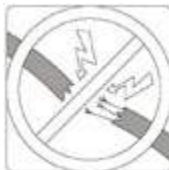
Überprüfen Sie das Gerät auf beschädigte Kabel.
