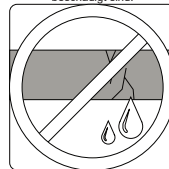
Prüfen Sie, ob der Kältemittelkreislauf dicht ist.
