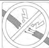
Sprawdzić urządzenie pod względem uszkodzonych przewodów
