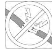
Überprüfen Sie das Gerät auf beschädigte Kabel.
